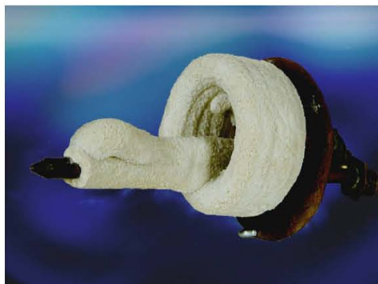
Αντίσταση πλυντηρίου μετά από εκτεταμένη χρήση "σκληρού" νερού.
